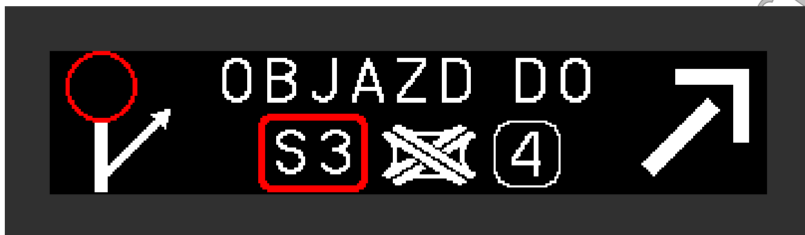
Rys. 5.7.6. Przykładowa wiadomość tekstowa na TZT-DP informująca o przekierowaniu na trasę alternatywną.
